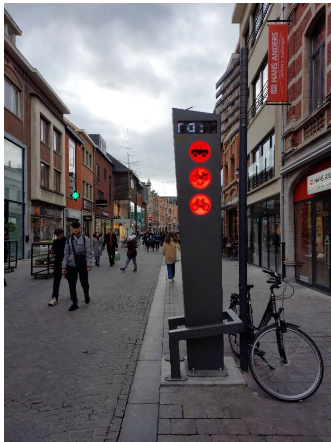
Εικόνα 7-10: Προστατευμένο από την κυκλοφορία κέντρο του Λευθεν. Στύλος με φωτεινές ενδείξεις επιτρεπόμενων οχημάτων ανάλογα με την ώρα της ημέρας
